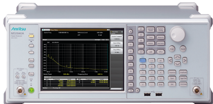
Spektrumanalysatoren MS2840A kan teste signaler opp til 44 GHz, og skal være egnet for alle relevante mobilstandarder, inkludert 5G.
